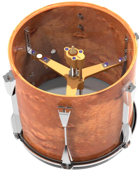
Abbildung 3.71: Nutzung einer höhenverstellbaren Sensorplattform
