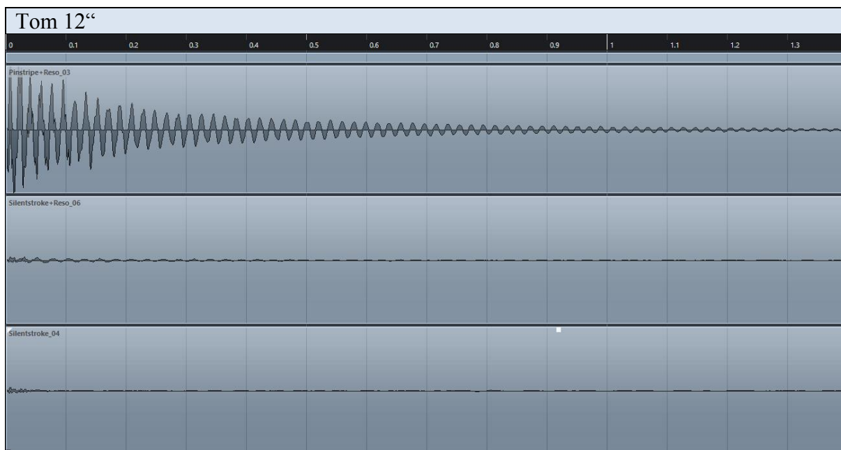
Abbildung 3.12: Einfluss der Dämpfung auf das Abklingverhalten - 12“-Tom
