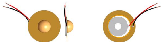
Abbildung 3.57: Sensoraufbau für Montage am Fellrand
