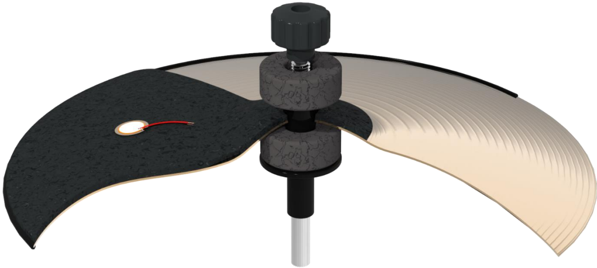
Abbildung 3.81: Klebung des Piezosensors auf die Dämpfungsmatte
