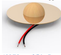
Abbildung 3.76: Sensor mit Holzerner Halbkugel und M4-Unterlegscheibe
