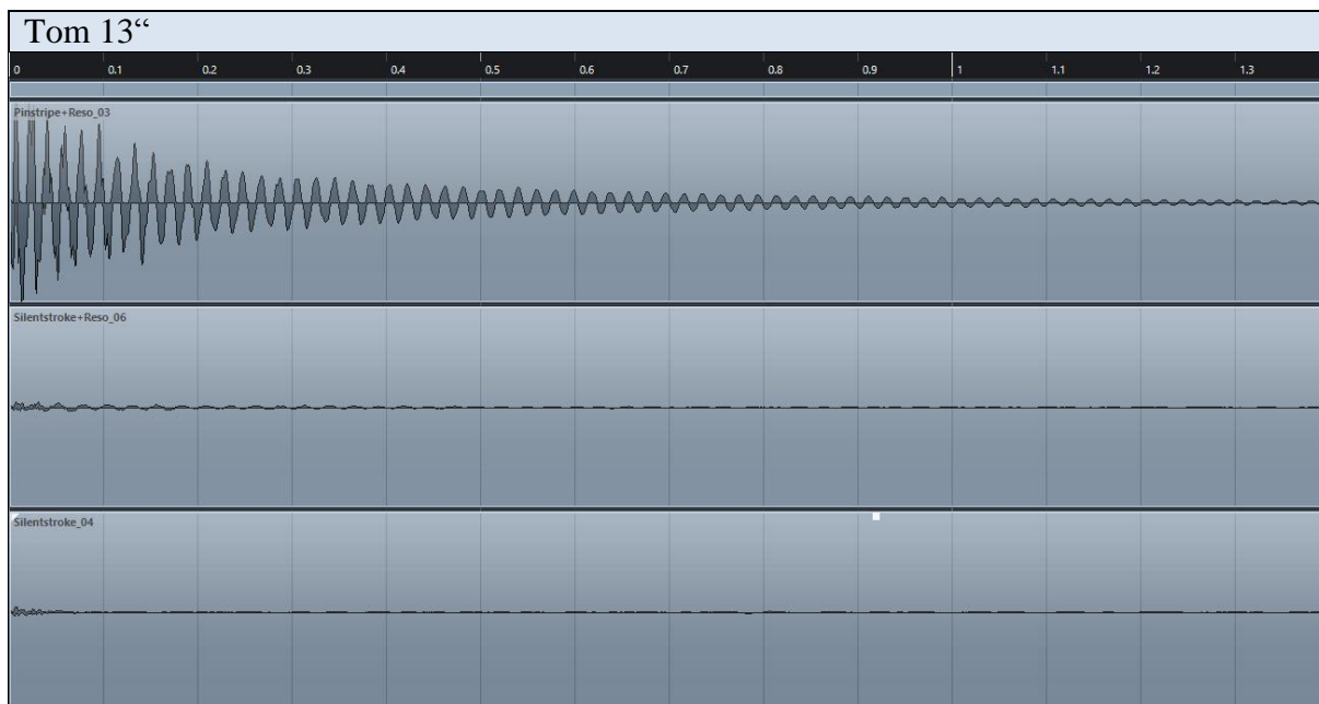
Abbildung 3.11: Einfluss der Dämpfung auf das Abklingverhalten - 13“-Tom
