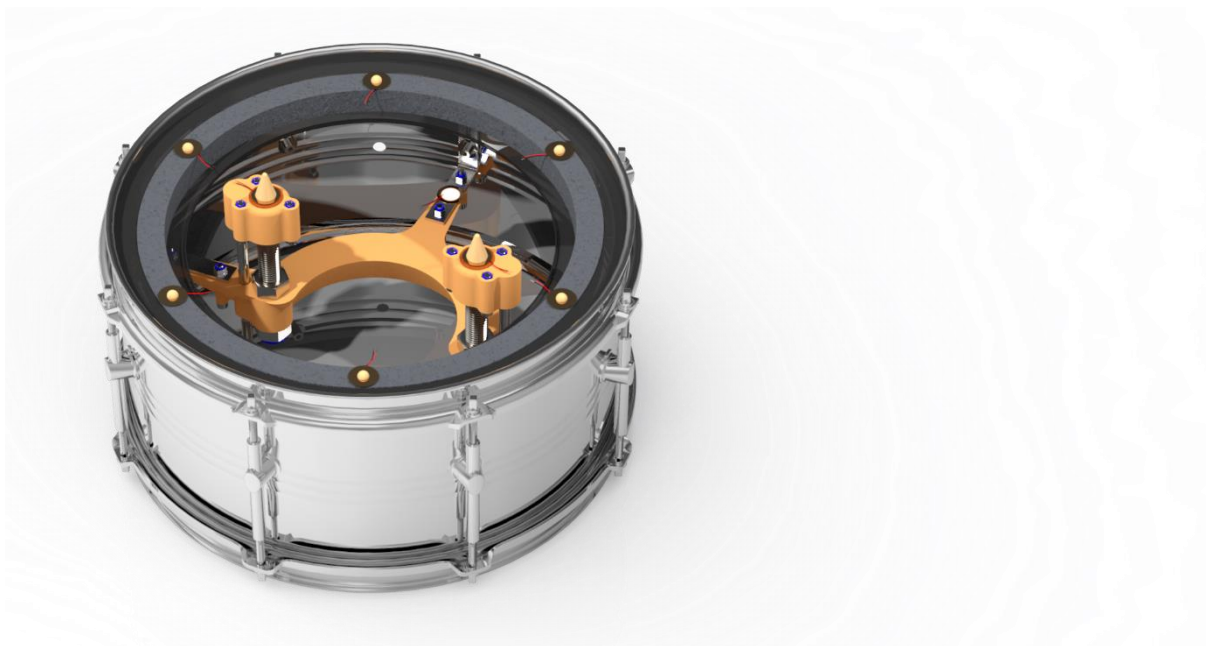
Abbildung 3.78: Snare mit Sensorik
