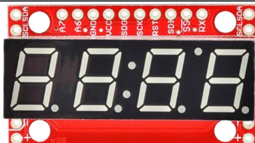
Abbildung 3.127: Sparkfun Serielle 7-Segmentanzeige 22
