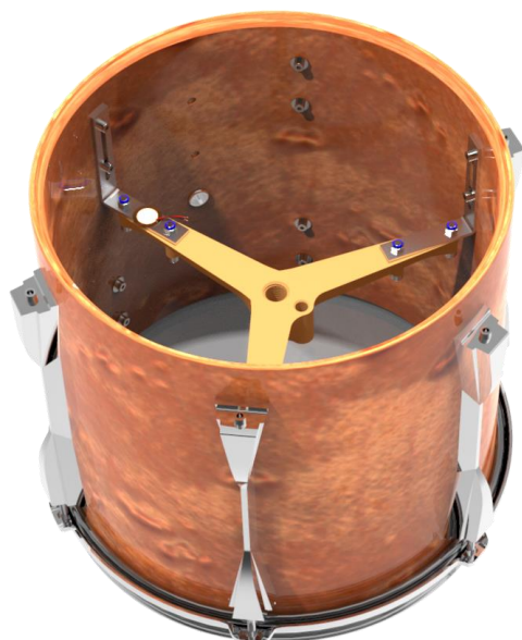
Abbildung 3.70: Befestigung der Sensorbrücke unter den Winkeln
